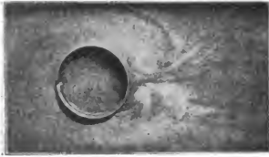
Abb. 110a. Entstehung der Wirbel nach Prandtl.
